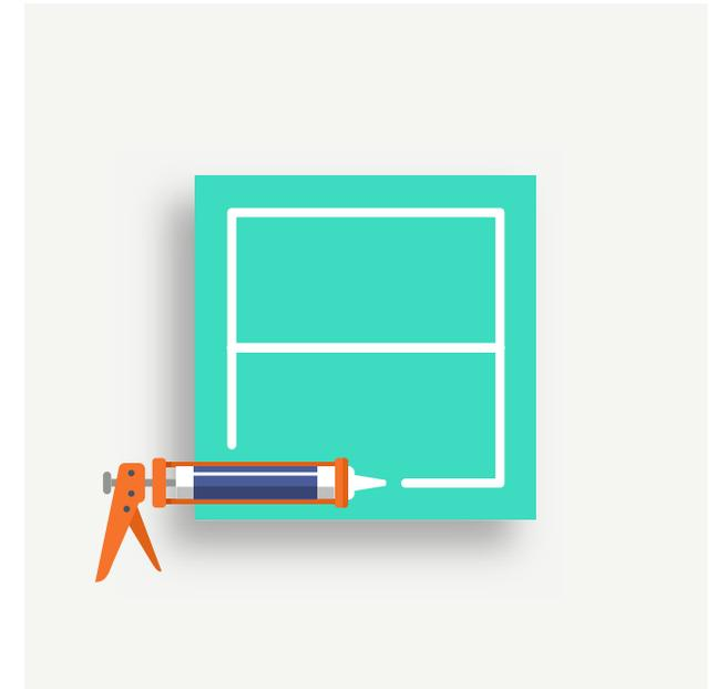
Aplique el adhesivo en varias líneas en el dorso del panel. No aplicar muy cerca de los bordes. Se requiere un mínimo de 450mm de cordón de adhesivo por Kg de peso del panel.
