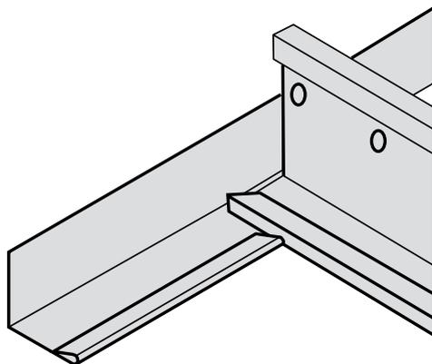
Para el apoyo del perfil con el ángulo de borde, se debe cortar y eliminar la junta del ángulo en ese encuentro.
