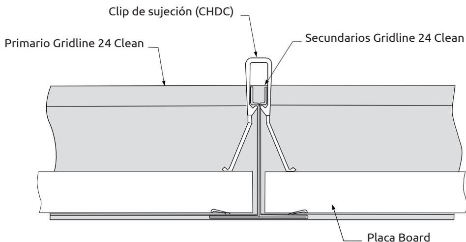
En caso de alta presión de aire desde abajo, se deben usar los clips de sujeción para evitar que las placas se levanten y para proporcionar hermeticidad.
